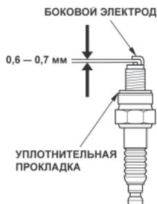
7. При установке новой свечи зажигания затяните ее еще на пол-оборота, после того, как свеча села на место, чтобы сжать уплотнительную шайбу.
