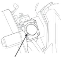
ВЫКЛЮЧАТЕЛЬ ДВИГАТЕЛЯ (применяемые типы)
