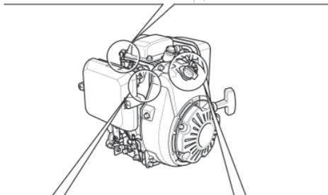
ГРУША ДЛЯ ПРЕДВАРИТЕЛЬНОЙ ПОДКАЧКИ ТОПЛИВА (применяемые типы)
